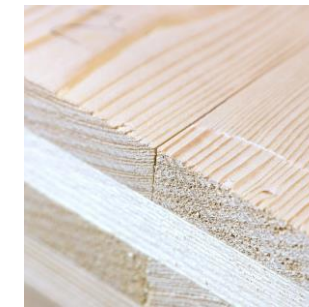
Kesilmiş kereste yüzünde çatlaklar
