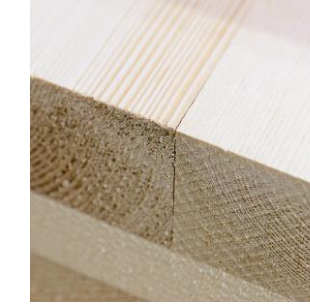
Kesilmiş kereste yüzünde mikro çatlaklar
